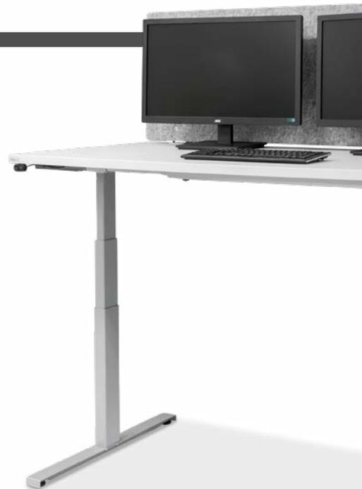
Structure robuste composée d'unités linéaires de 50 x 80 mm combinées à des profils de pied en acier et à une traverse supérieure télescopique (1150 – 1750 mm). Montage facile des colonnes de levage grâce à un système d'encliquetage. Revêtement par poudre de haute qualité en aluminium blanc RAL 9006.
