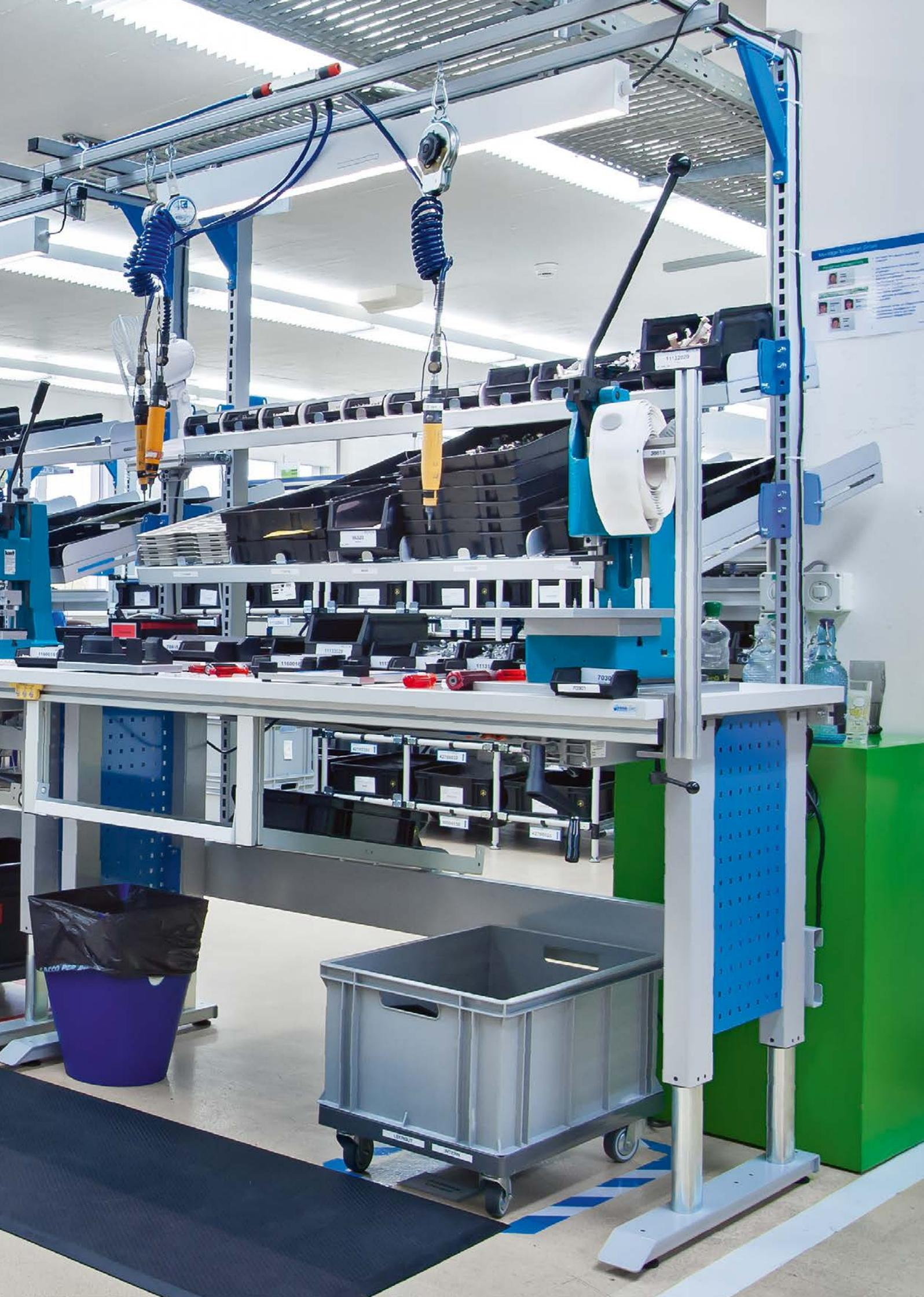
Les superstructures indépendantes offrent une solution de recharge économique par rapport à une table. Par ex. si le système convoyage existe déjà et que l'on veut tout simplement intégrer un processus de conditionnement. Diverses largeurs de trame sont combinables à souhait.
