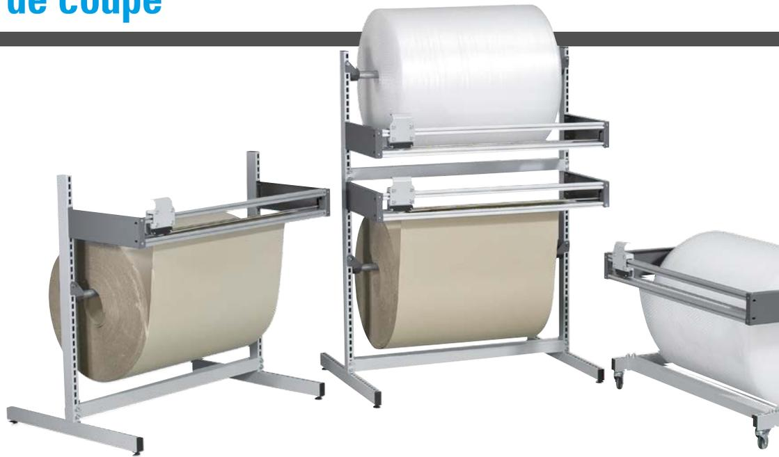
Pour couper le matériau enroulé telle que carton ondulé, papier d'emballage et papier bulle. Adapté aux rouleaux avec un diamètre jusqu'à 750 mm, une largeur max. de 1600 mm et un poids de 150 kg.
