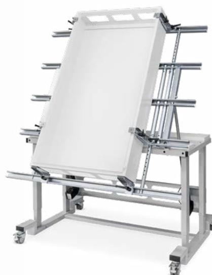
Le châssis de base ERGO-Mont est constitué d'une construction massive en tube d'acier et de quatre unités linéaires réglables en hauteur sur 500 mm grâce à un moteur électrique. L'inclinaison du plan de travail peut également être réglée par un moteur électrique. Un cadre de base télescopique et un système de fixation flexible avec des supports latéraux permettent de fixer facilement les panneaux de montage et les armoires électriques.
