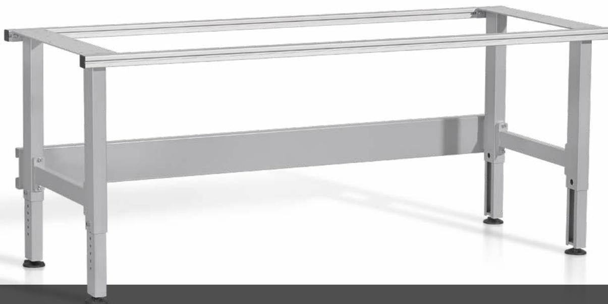
Le châssis ERGO-Forte est la solution parfaite pour des postes de travail massifs avec une tenue stable. Grâce à une glissière de qualité, la table reste très robuste, même en position entièrement déployée. En standard, il dispose d'une plage de réglage de 300 mm. Sur demande, celui-ci est extensible jusqu'à 400 mm.
