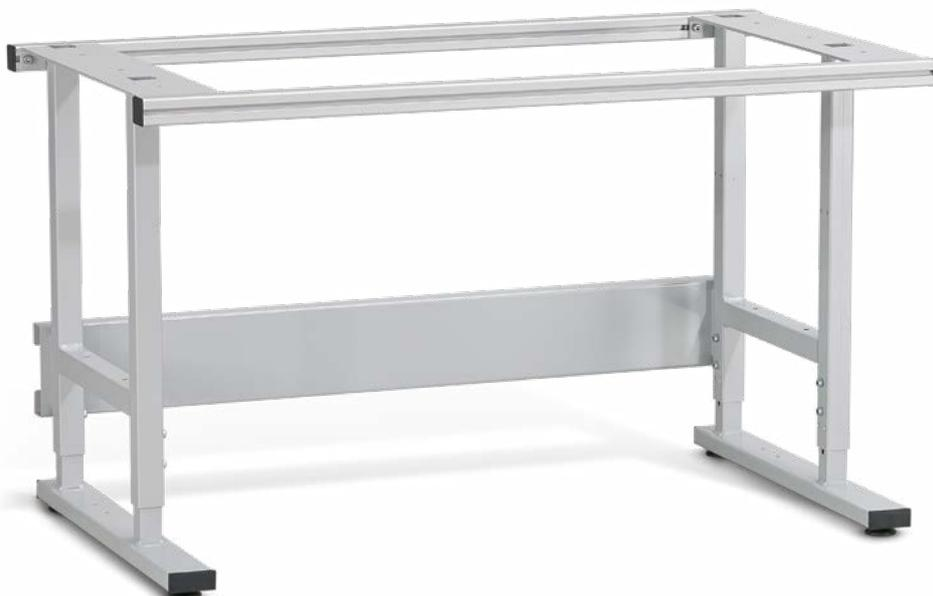
Structure robuste en tube d'acier de 40 x 40 mm combinée avec un profilé arrière en C robuste pour logement des superstructures. Pour le logement supérieur des plans de travail ainsi que la fixation des tiroirs, on utilise des profilés alu de 40 x 40 mm. Thermolaquage de pointe en aluminium blanc RAL 9006.
