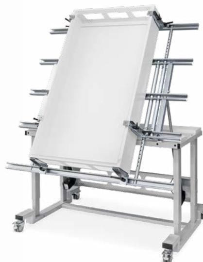
Das ERGO-Mont Grundgestell besteht aus einer massiven Konstruktion aus Stahlrohr und vier höhenverstellbaren Lineareinheiten, welche über einen Elektromotor 500 mm in der Höhe verstellbar sind. Auch die Arbeitsfläche kann über einen Elektromotor in der Neigung verstellt werden. Ein teleskopierbarer Grundrahmen und ein flexibles Befestigungssystem mit seitlichen Halterungen ermöglichen ein einfaches Fixieren der Montageplatten und Schaltschränken.
